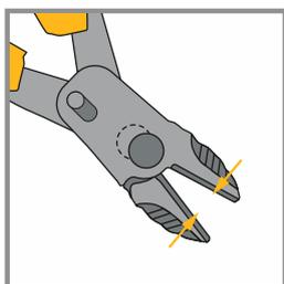
✓ **ИНДУКЦИОННАЯ ЗАКАЛКА РЕЖУЩИХ КРОМОК**
